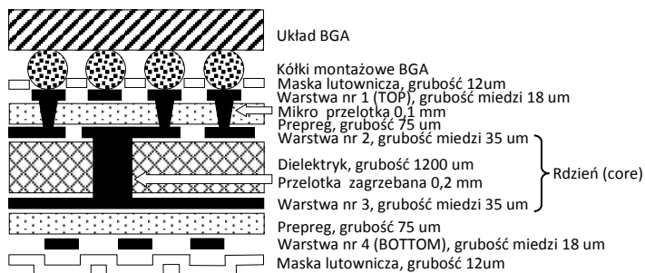
Typowa struktura czterowarstwowej HDI
