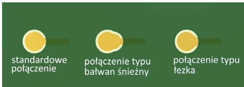
Rys. 21. a. standardowe połączenie b. połączenie snowman c. połączenie w kształcie łezki
