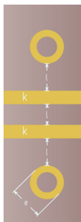
Rys. 7. Fragment trasowania z jedną ścieżką pomiędzy padami.
